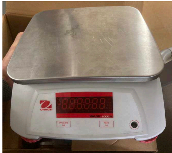
Figure 12 : Balance OHAUS® Valor2000W™ utilisée pour les pesées lors de l'étude
