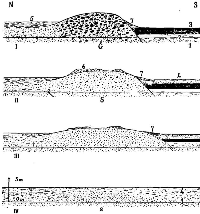
FIG. 13. — Coupes demi-schématiques montrant les relations du cordon littoral des Pierrettes avec les dépôts poldériens et tourbeux du Calais.
