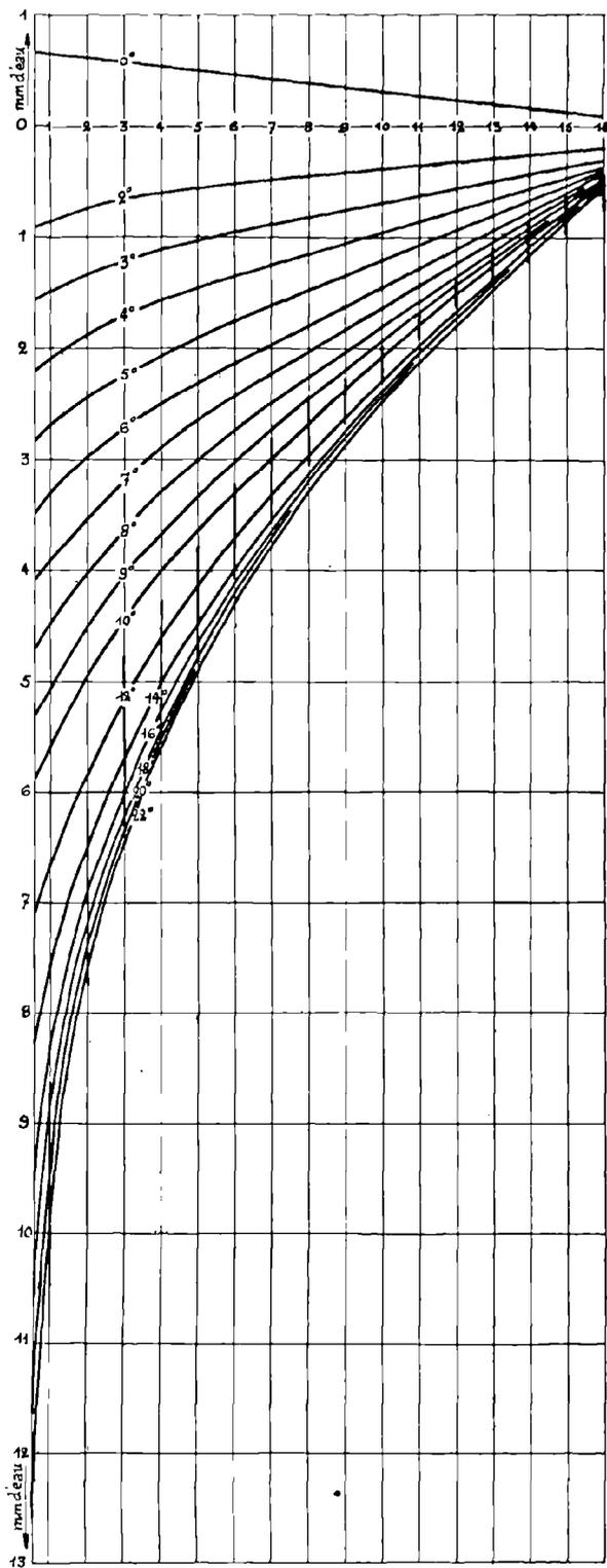
Fig. 18. — Distribution de la pression statique le long du plan supérieur du divergent, pour des angles d'ouverture variant de 0 à 30°.
