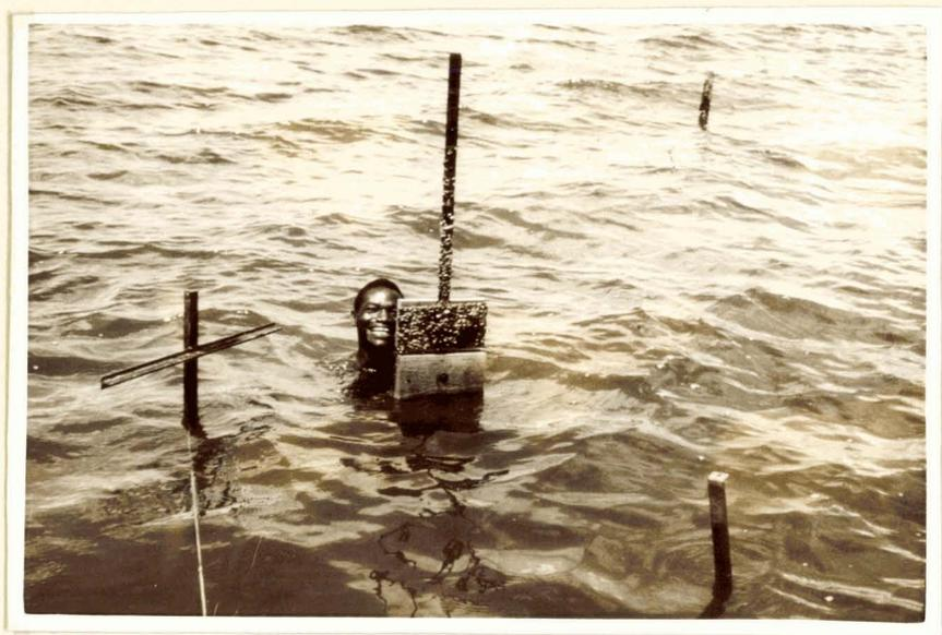
Figure 16 (b) - Appareil collecteur à tarets. Mise en place des fers DD et D' D' par un pêcheur. (L'extrémité supérieure de AA et le fer BB sont visibles).
