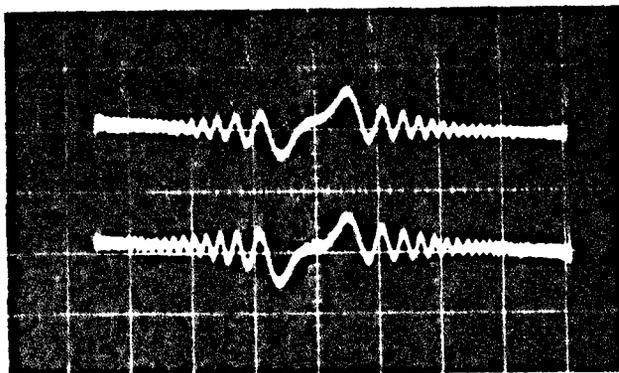
Benzène -  $H_I = 32,4 \text{ mG}$  -  $\Delta H = 3,7 \text{ G}$
