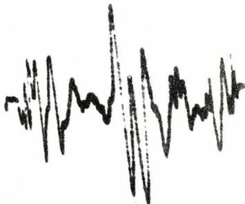
Fig. II.5. - Les signaux positifs (en haut) correspondent aux raies d'absorption et les signaux négatifs à leurs composantes Stark. La photographie étant prise à pression relativement forte, toute irrégularité du signal représente une ou plusieurs raies non résolues. La largeur du spectrogramme est de l'ordre de 50 MHz.
