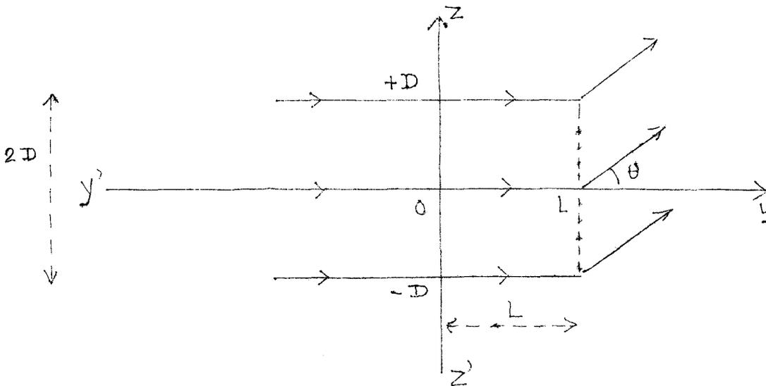
Fig 2.1 Propagation d'une onde lumineuse diffractée dans la direction  $\theta$ .
