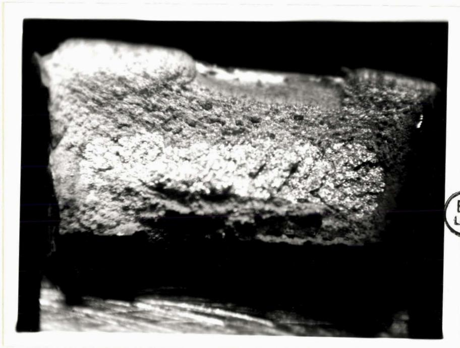
Photo N° 2 - Cassure d'éprouvettes revenue
