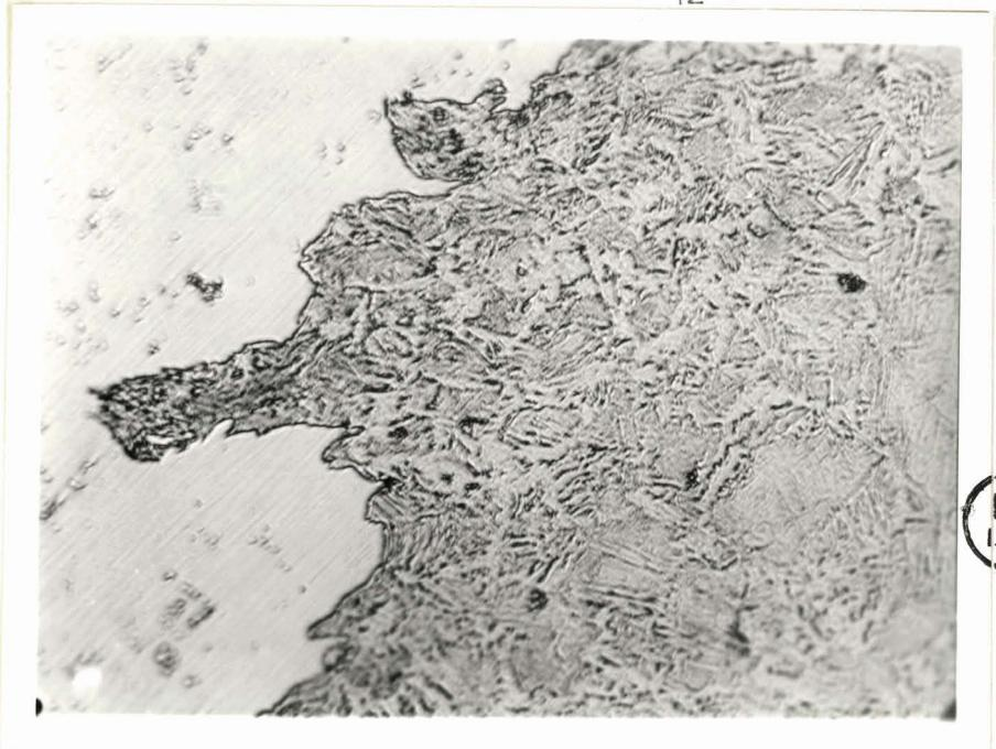
Photo N° 4 - Coupe Nickelée d'une éprouvette trempée et revenue à 150° C cassée à l'ambiante G = 900
