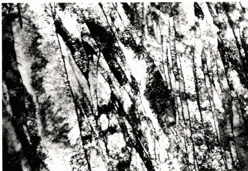
Photo n° 9 - Micrographie électronique lame mince acier trempé G = 40.000
