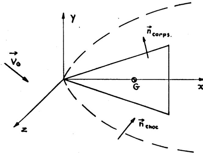
Soit  $\vec{\Omega}$  le taux de rotation du cône par rapport à l'air au repos en amont,
