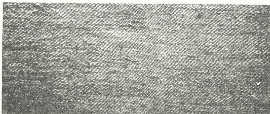
Figure 1.1 : Exemples de tissus dont la trame présente une irrégularité périodique
