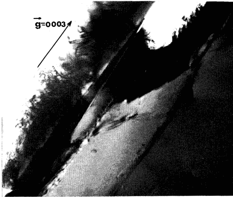
Figure 7 - 12 : Dislocations contenues dans une lame (11\bar{2}0) (x 37 000 )
