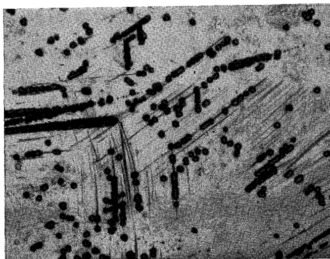
Figure 6 - 8 : Surface griffée, le bain E révèle les dislocations fraîches sur un plan (0001) échantillon W , température 110^\circ , attaque 4'', densité de dislocations locale 10^6 \text{ d / cm}^2 . ( \times 200 )
