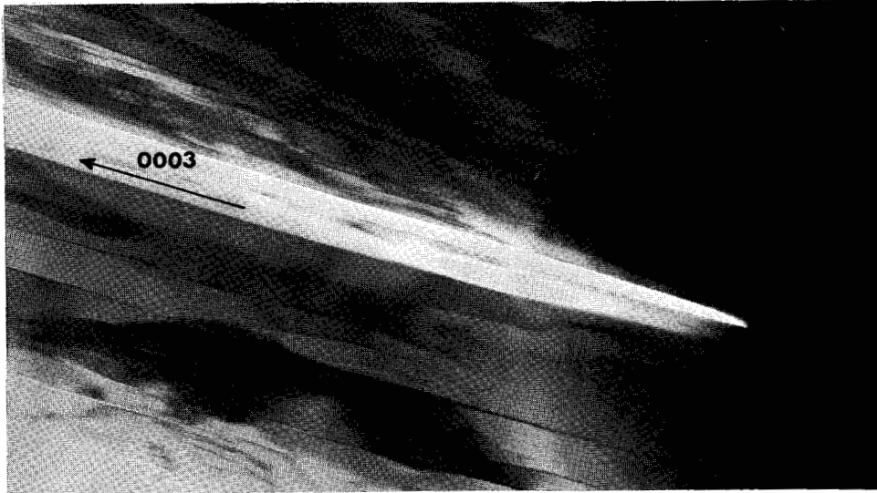
Figure 8 - 15 : Lamelle (10\bar{1}0) , échantillon déformé de 3 %. Les dislocations sont toutes alignées selon [0001] . ( \times 3\ 800 )
