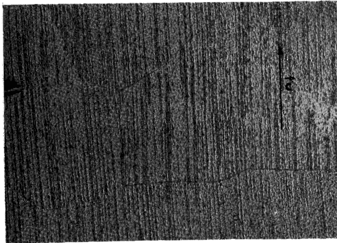
Figure 6 - 12 : Echantillon C recuit ; légèrement serré dans des pinces, attaque au bain F 6'' à 150^{\circ}\text{C} . face (0001). ( x 640 )
