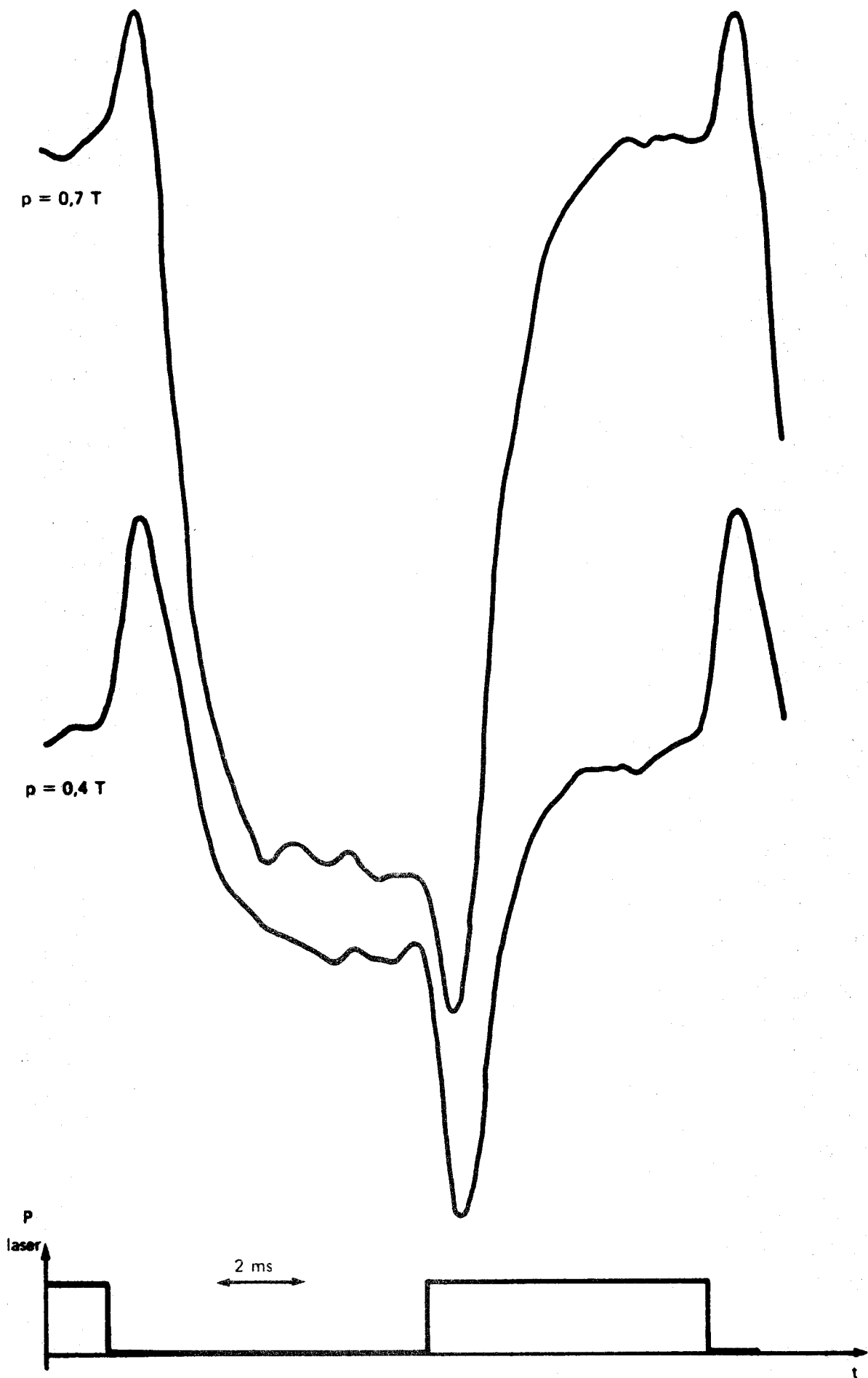
figure 11: Evolution de la forme du signal de sonde pour des pressions de protoxyde d'azote inférieures à 1 Torr.
