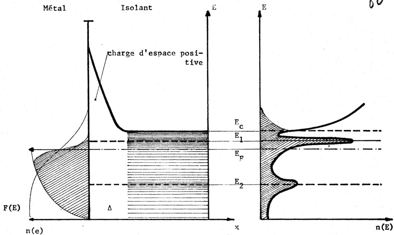
Le niveau d'énergie situé à  $2 \cdot 10^{-2}$  eV au dessous de la bande de conduction de l'isolant est dû à sa structure amorphe (15) et se présente certainement plutôt sous forme de bande étroite.
