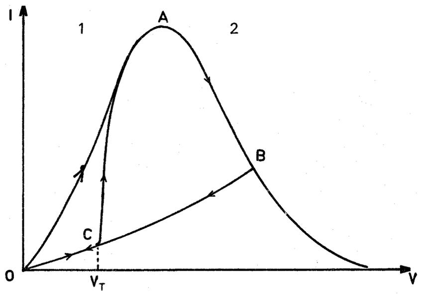
Lorsqu'on applique au dispositif une tension en dent de scie, dont le temps de retour à zéro est faible ( $< 1$  ms) le point de fonctionnement décrit le cycle O A B C O.
