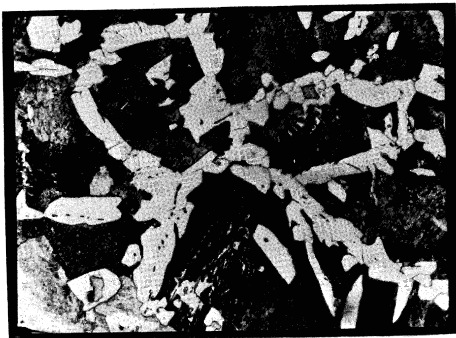
M 6 a. Acier XC 38 au bore surchauffé à 1150°. V r = 20°/mm. Grossissement : 300. Attaque Nital.
