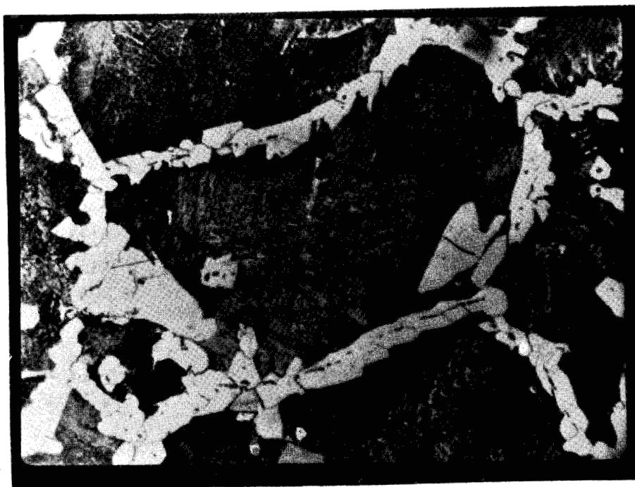
M 6 b. Acier XC 38 au bore surchauffé à 1250°. V r = 20°/mm. Grossissement : 300. Attaque Nital.
