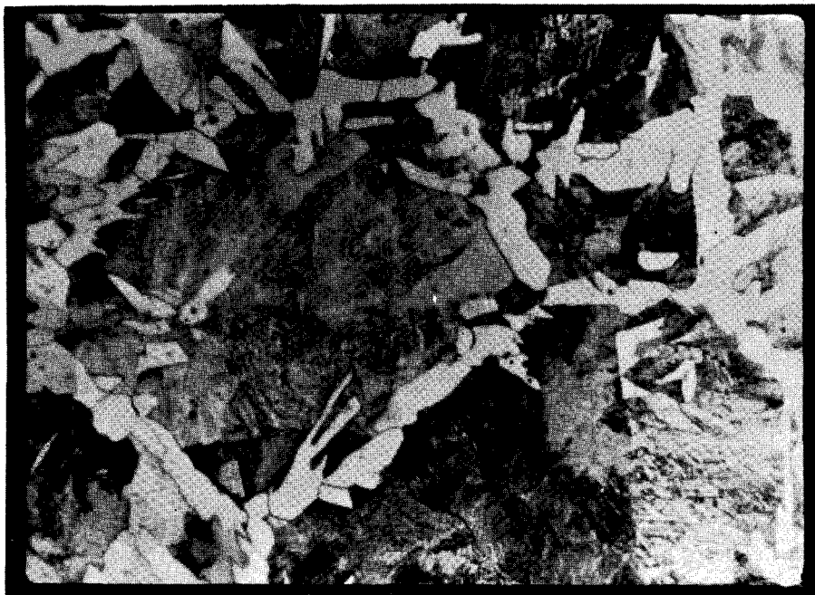
M 7. Acier XC 38 classique surchauffé à 1150°. V_r = 20^\circ/\text{mn} . Grossissement : 300. Attaque Nital.
