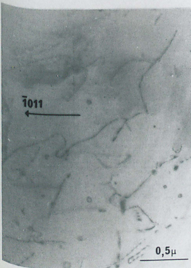
18 : Quartz de S t Paul La Roche. Les dislocations ( a ) ont des composantes vis et coin.
