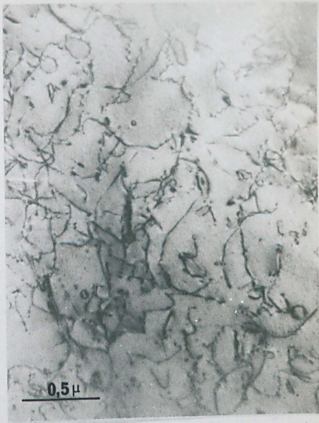
13 : Granulite d'Ansignan . Forte densité de dislocations. ( 5 \times 10^9 \text{cm}^{-2} )
