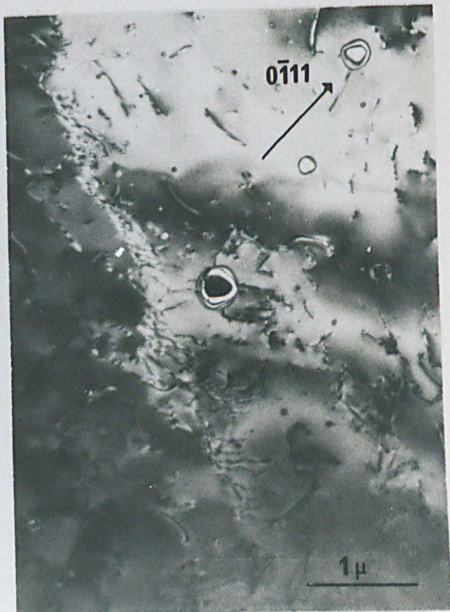
15 : Quartz de St Paul La Roche Amas de dislocations donnant une allure de sous-joint.
