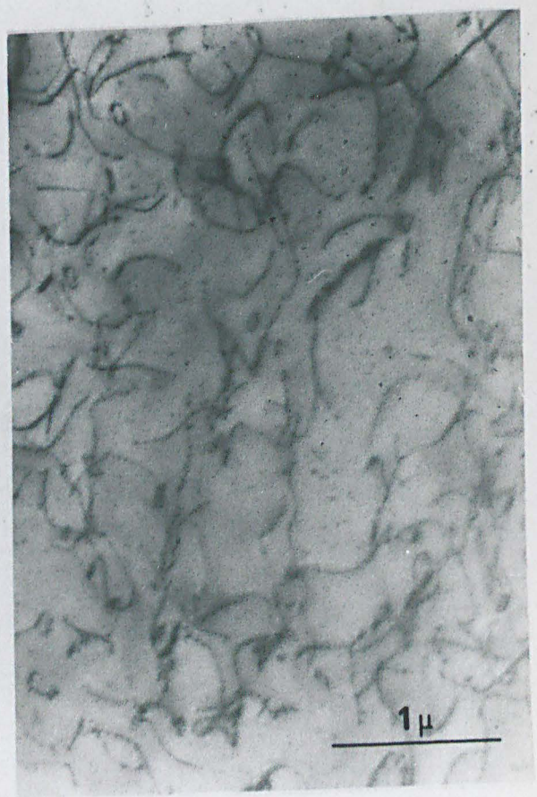
19 : Granulite d'Ansignan. Les lignes de dislocations sont gauches.
