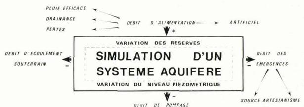
Fig. 2. — Les éléments dynamiques d'un système aquifère. On notera, à la différence des éléments statiques (fig. 1), que chacun des éléments dynamiques est variable dans le temps. La recherche de l'équilibre d'un système aquifère conduit à proposer des caractéristiques dynamiques intrinsèques.
