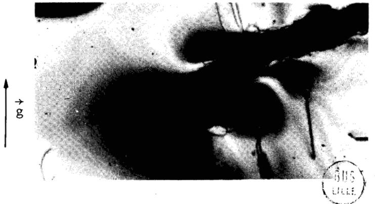
• *Figure 6 a et b* : Même lame (001) - Franges d'égale déformation dans le cristal parfait environnant - Réflexion  $(\bar{2}22)$  - ( $\times 12$ )
