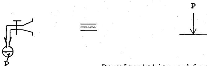
Représentation schématique de l'introduction d'un précurseur P, d'un solvant S ou d'un gaz G dans le ligne de vide.
