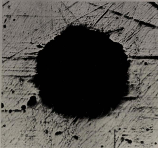
Figure 4.1 Exemple d'orifices de pression
