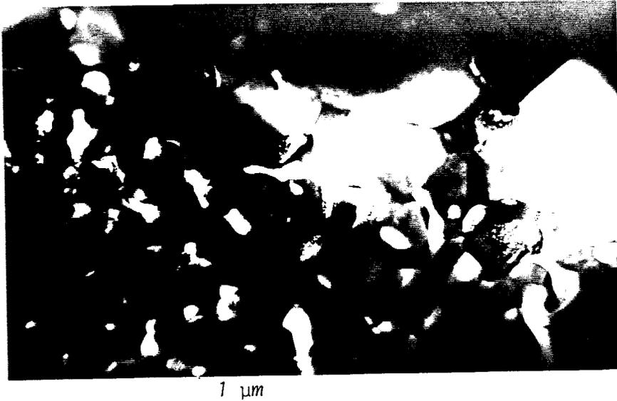
Fig 2.7 (b) Micrographie d'un échantillon recuit 1 h à 1100°C. Croissance de grain inhibée dans la zone poreuse ;  $d = 96\% d_{th}$ .
