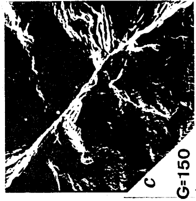
Acier D . \Delta \epsilon_t : 2 % a) zone d'amorçages multiples ~ b) stries de fatigue ~ c) détail de b) ~ d) cupules ductiles . zone de rupture finale .
