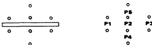
Après avoir effectué une saignée qui provoque une décompression locale du massif, on y introduit un vérin plat qui épouse la forme de celle-ci. Ce vérin est mis en pression jusqu'à rétablir la pression dans le massif, ce qui est réalisé lorsque les distances entre les différents plots sont retrouvées. La contrainte déterminée est unidirectionnelle et perpendiculaire à la saignée, elle peut ne pas être principale.
