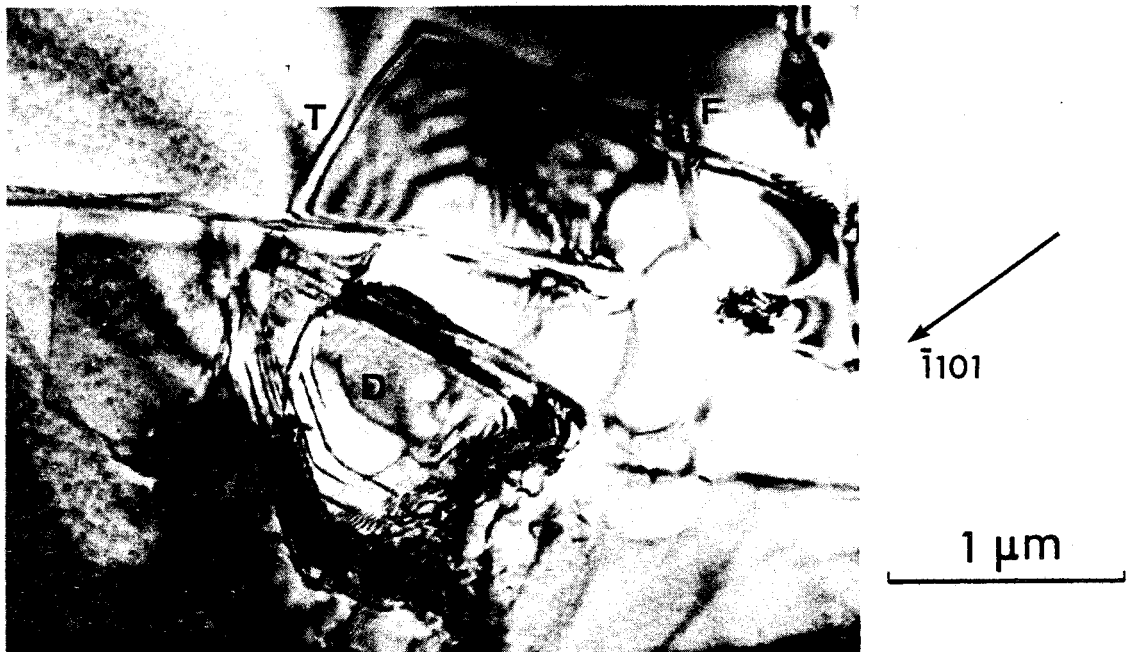
Figure III-9. Micrographie électronique d'une indentation sur une face (10\bar{1}0) . On observe des boucles de dislocations (D), des microfractures (F) (visibles par les franges de Moiré) et des macles du Dauphiné (T). Lame (10\bar{1}0) .
