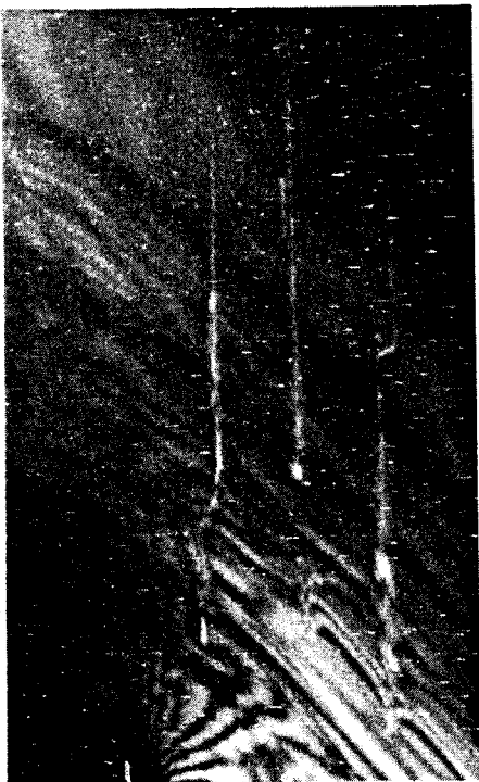
Figure A-92. Succession d'images sous irradiation croissante vue perpendiculairement au plan de glissement. Aucun contraste double. Pas de zone amorphe. Les dislocations sortent de la lame. Lamelle (1\ 1\ \bar{2}\ 0) .
