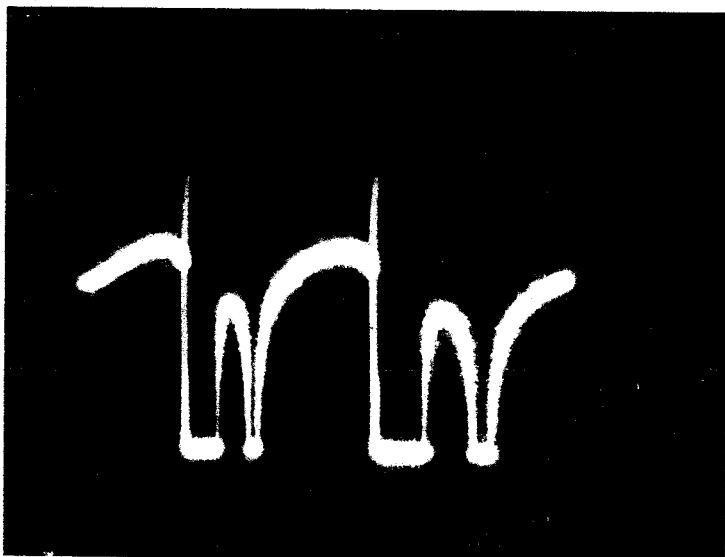
FIGURE II-1 : Profils d'émission laser observés pour différentes pressions de \text{CH}_3\text{Br} dans la cavité laser; émission laser : 10P20 la pression d'absorbant croît vers le bas.
