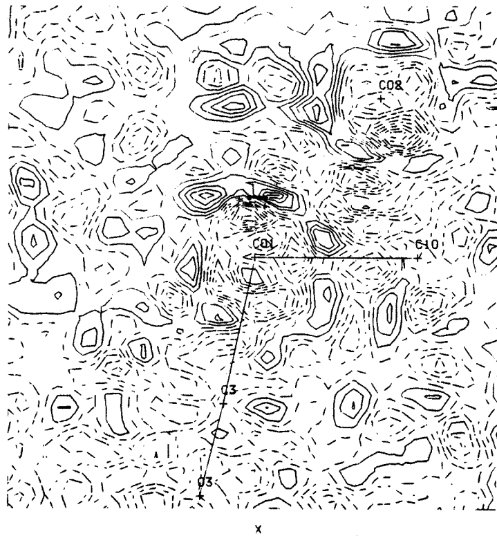
Figure IV-20 : Densité résiduelle dans le plan (C_3, Co_1, C_{10}) - Modèle 3 - pas de contours 0.05 e^{-/A^3}
