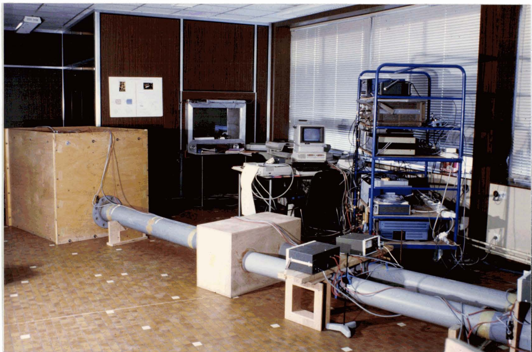
Figure 118 - b : Mise en parallèle de deux ventilateurs transverses - Vue partielle du montage expérimental
