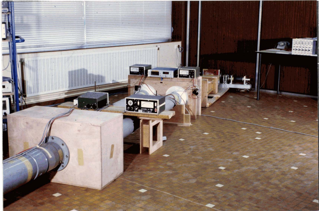
Figure 118 - a : Mise en parallèle de deux ventilateurs transverses - Vue partielle du montage expérimental
