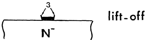
Figure 16 : Métallisation du contact T_i/P_t/T_i/A_u
