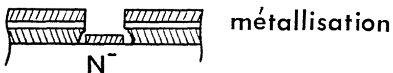
Figure 17 : Profil de gravure "en casquette" s'obtient par trempage dans du chlorobenzène après enduction et préséchage de la résine.
