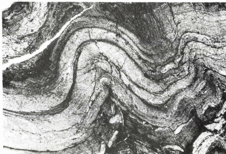
Photo 37 - Lame mince d'un pli tardif qui affecte une schistosité de flux antérieure. Une schistosité de type strain slip apparaît au coeur du pli dans les pelites (x 1).
