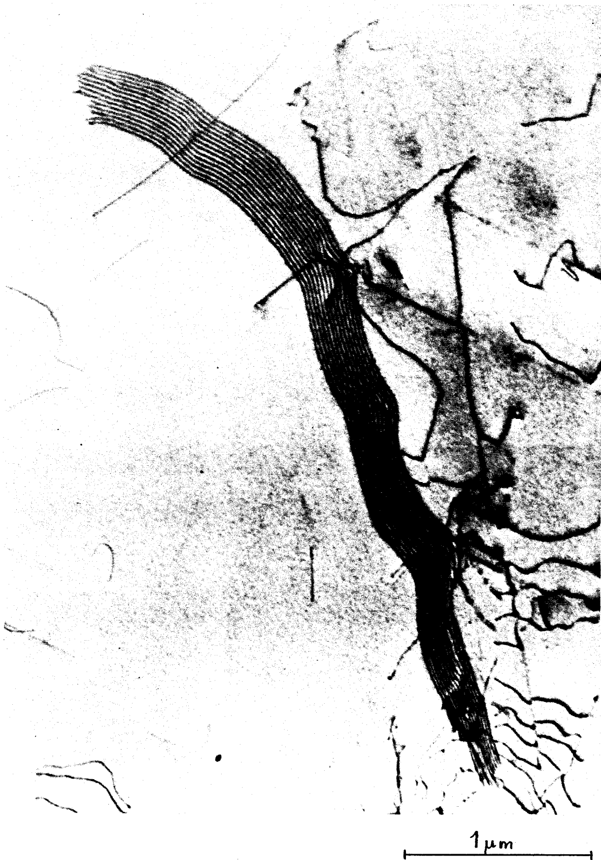
Fig. 60 - Micrographie électronique en transmission (1 MV). Multipôle observé dans la matrice du composite Ni(Cr)-TaC déformé en traction-compression ( \pm 300 MPa, N_R = 1\ 270\ 000 cycles).
