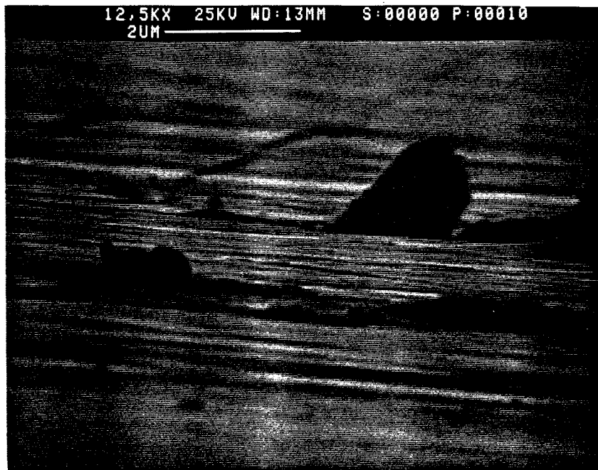
Fig. 67 - Micrographie électronique en balayage révélant la présence d'extrusions sur le fût préalablement poli d'une éprouvette de matrice seule déformée en traction-compression ( \pm 400 MPa, N_R = 5500 cycles)
