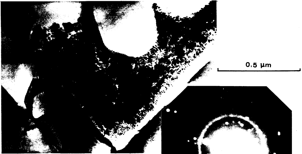
a. Zone de dévitrification
