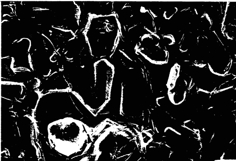
b. Après fluage à 1266°C pendant 62 heures. Les fissures et le déchaussement du grain sont occasionnés par la contrainte appliquée (200 MPa).
