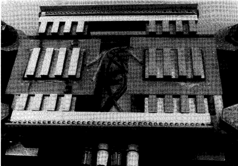
Photo. A1.3. - Vue de dessus des dentures de l'armature fixe
