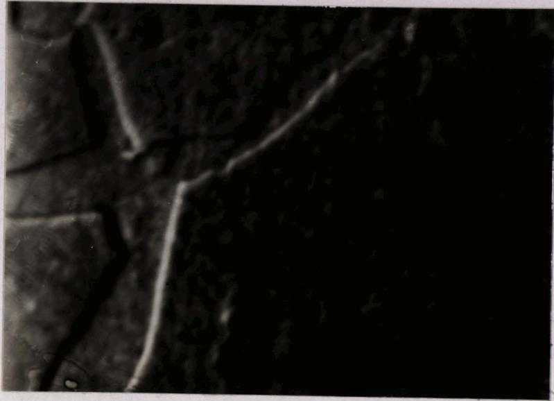
photo 6 : Diffusion dans les joints de grains.
