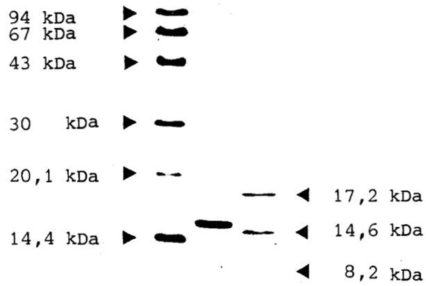
Figure 16 : Analyse de l'angiogénine bovine en gel de polyacrylamide à 15 % en présence de SDS et de  $\beta$ -mercaptoéthanol.
