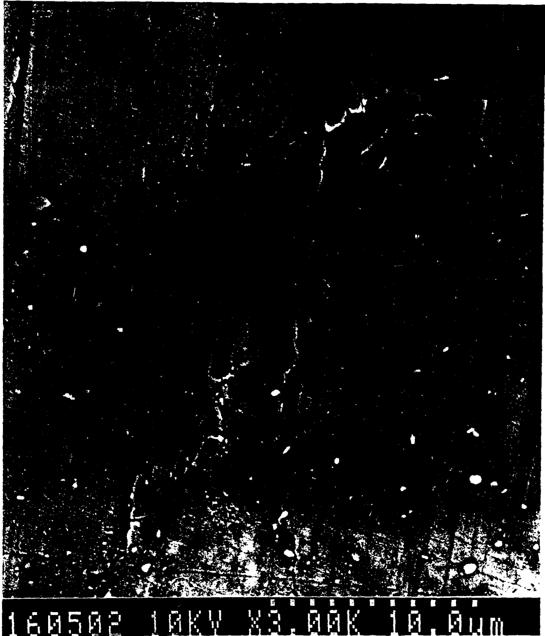
Figure 30 : observation au M.E.B. illustrant les mécanismes qui se produisent dans la zone de transition entre les deux phases de propagation.
