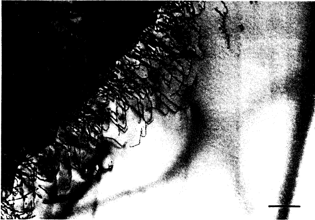
Figure VI-3.b: Echantillon SICN 229 déformé à 0.7% Même configuration que ci-dessus - Barre d'échelle: 1 \mu\text{m}
