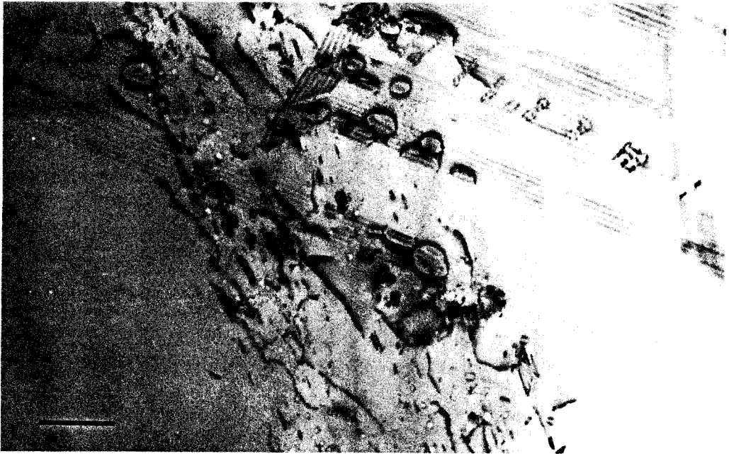
Figure IV-5: Lamelle d'améthyste naturelle du Brésil recuite deux heures à 500 °C g = 1100 - Barre d'échelle: 1 \mu m
