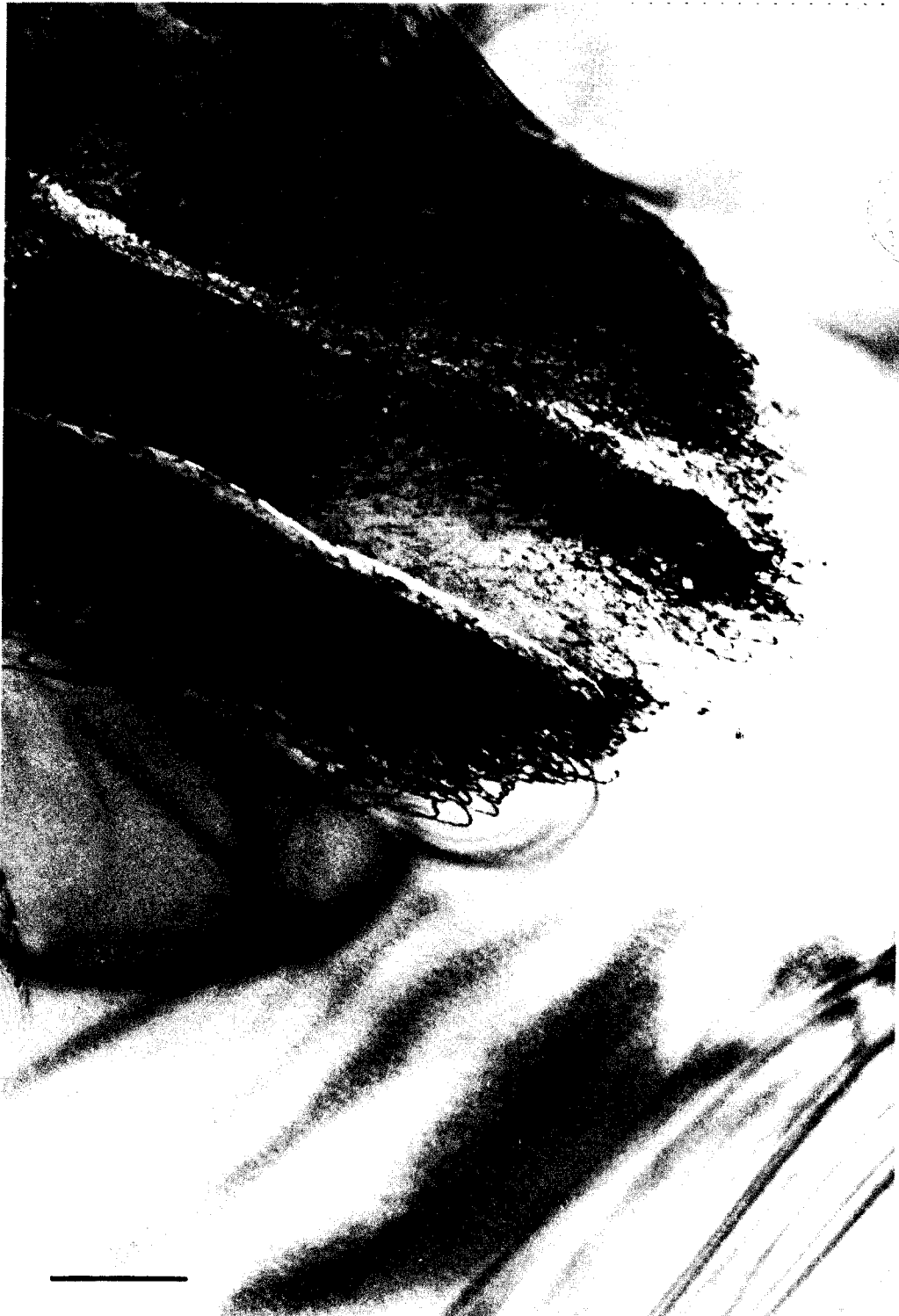
Figure VI-3.a: Echantillon 229 déformé à 0.7%. Dislocations amassées autour de fissures, ces dislocations sont restées dans le voisinage immédiat des fissures et n'ont pas participé à la déformation - Barre d'échelle: 1 \mu\text{m}
