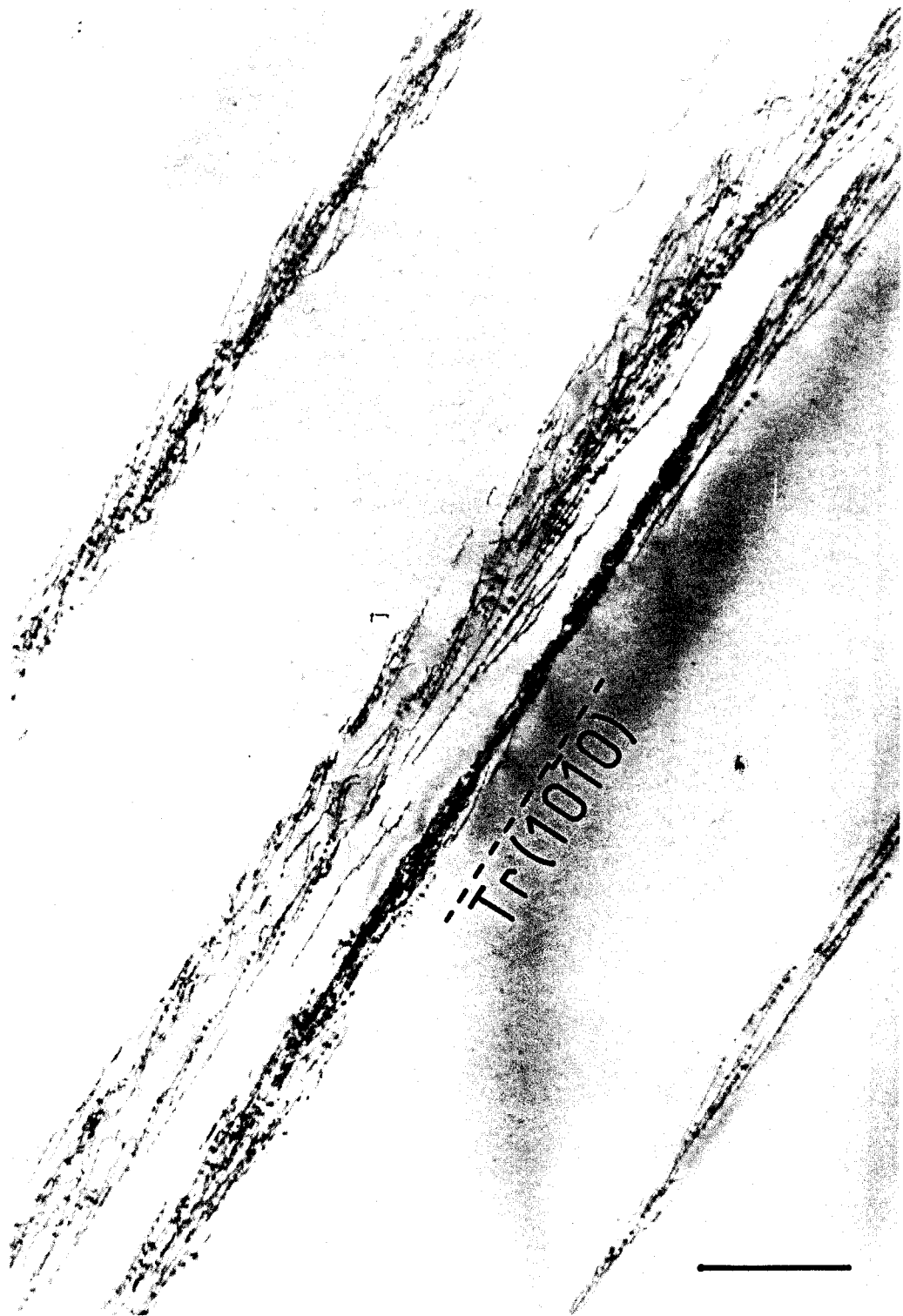
Figure VI-4.b: Echantillon SICN 229 déformé à 0.7% Bandes de glissement - Barre d'échelle: 1 \mu\text{m}
