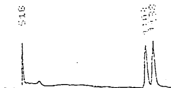
Schéma 4-7 A : Résolution de l'uréthane 22 racémique par la colonne CPG FS-Cyclodex bêta-I/P (25 m * 0,25 mm ID). Conditions : T_F = 160^\circ\text{C} , P_{N_2} = 1,2 bar.
