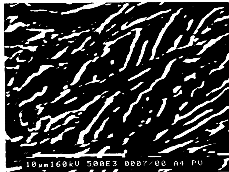
Figure 5 .6 : aspect des décohésions entre le "MA" et la matrice ferritique après traction par choc à -196^{\circ}\text{C}
