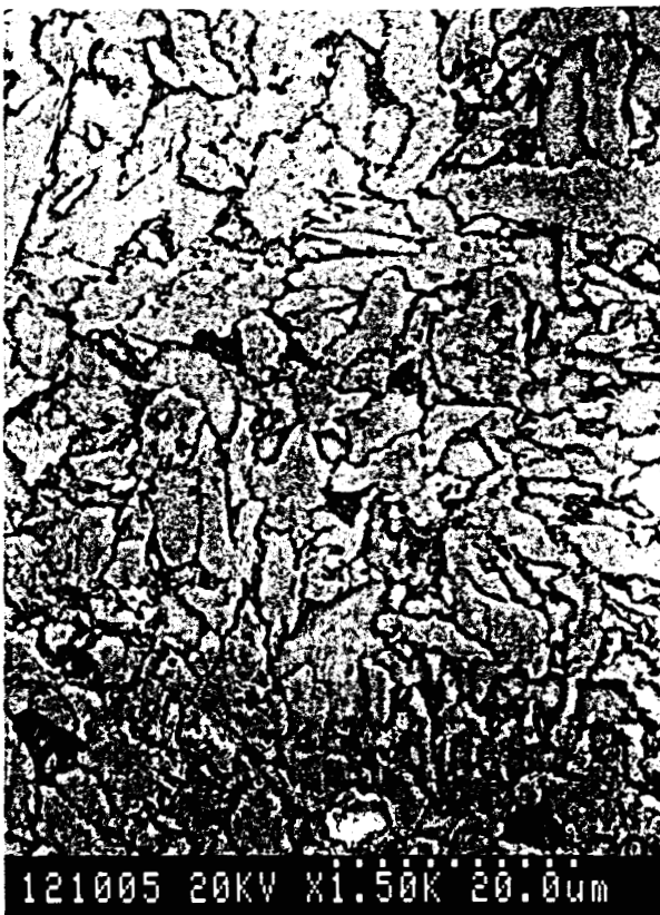
Photo II-12 : Structure de la Z.A.T. observée sur une longueur de 3mm
