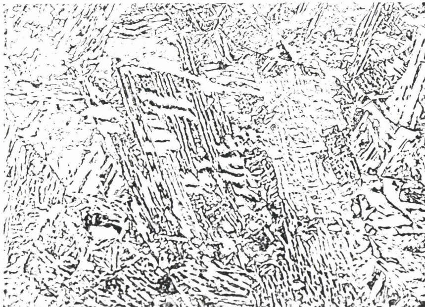
Photo II-28: Mélange de la bainite en lattes et de la bainite granulaire Gr. 600
