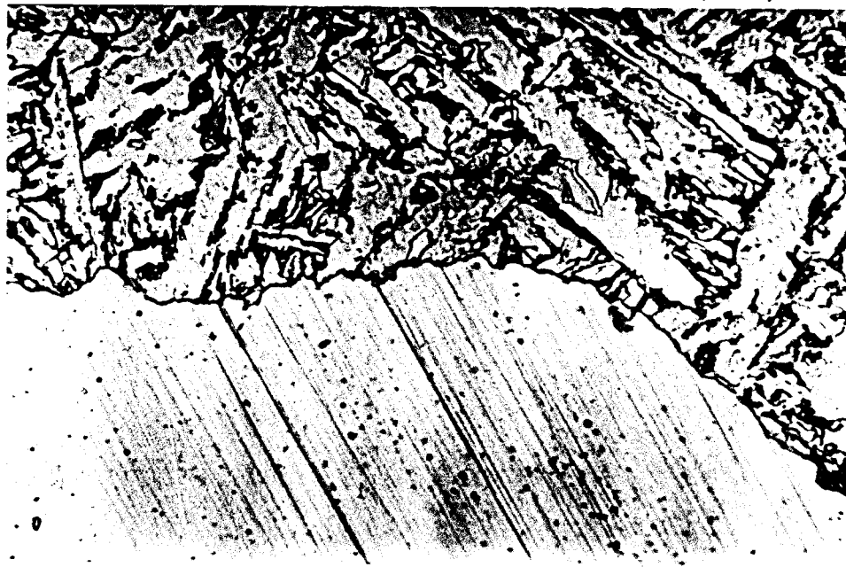
Photo V-3: Profil de la fissure de fatigue dans la structure hétérogène.(Gr.600)
