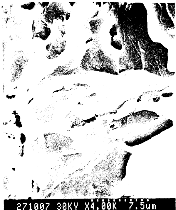
Photo III-3b, c: Aspect des faciès de rupture par choc à -20°C de la Z.A.T. du produit E70T7;4 passes (Nr Ech. 9-5) Positionnement de l'entaille : ferrite-perlite (8-10 \mu\text{m} )
