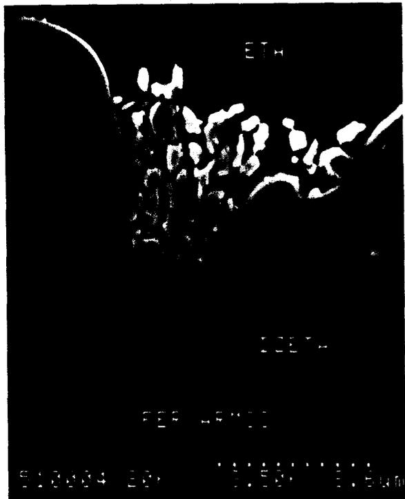
Figure II.57 : Images en microscopie électronique à balayage de l'échantillon de fer ARMCO immergé en bain de Zn-0.063%Ni-0.058%Al à 450°C
