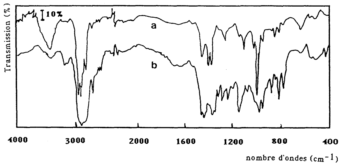
Figure (41) : spectre i.-r. du PP : (a) pulvérulent et (b) après mise en forme.
