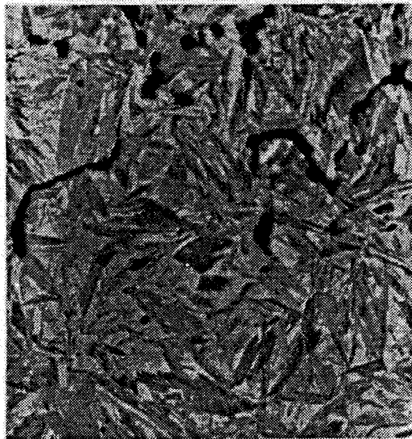
Figure 20 : Corrosion intergranulaire en surface (20 \mu\text{m} ) et quelques traces de porosité.
