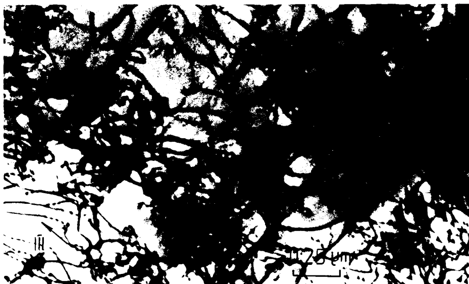
figure 2.21 : aspect difficile du glissement des dislocations dans l'acier 316L après 1/4 de cycle ( \epsilon_t = 1.25\% ), T = 77K (▼: Barrière de LOMER COTTRELL)
