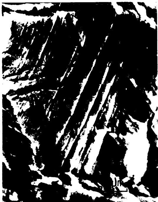
Figure 2.8 : faciès à stries fragiles acier 316LN, T = 77K faible \Delta K
