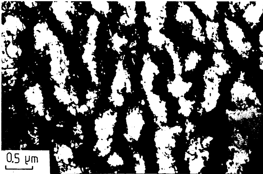
Figure 2.26 : murs à parois mal définies et peu condensées Acier 316LN, \Delta\varepsilon_t = 2.5\% , T = 300K , N_R = 1600 cycles
