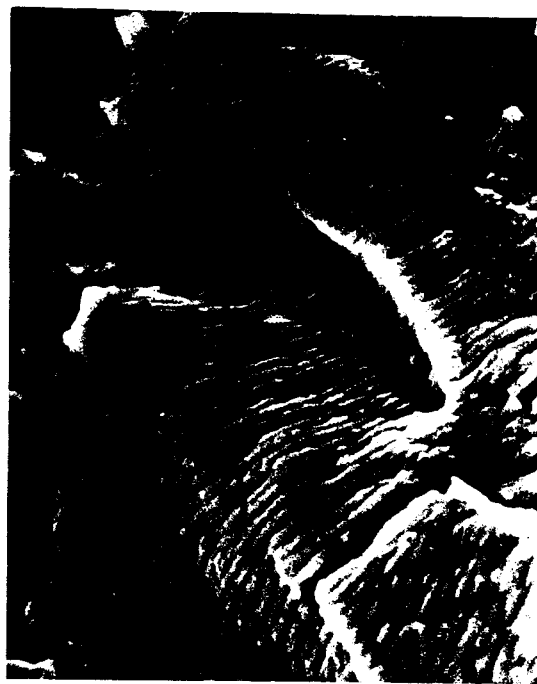
Figure 2.9 : faciès à stries ductiles acier 316LN, T = 77K \Delta K élevé
