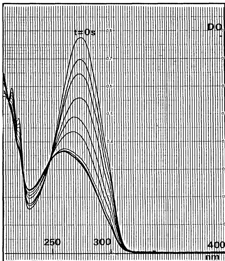
Figure 41 : Evolution des spectres U.V. sous irradiation en solution diluée du modèle N-isopropyl, cinnamamide
