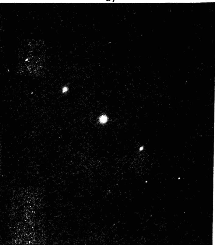
Figure 12 : Diagramme de diffraction électronique dans le plan a^*-b^* , (001)^* sur une céramique [phase (2201)]. Le paramètre de modulation
