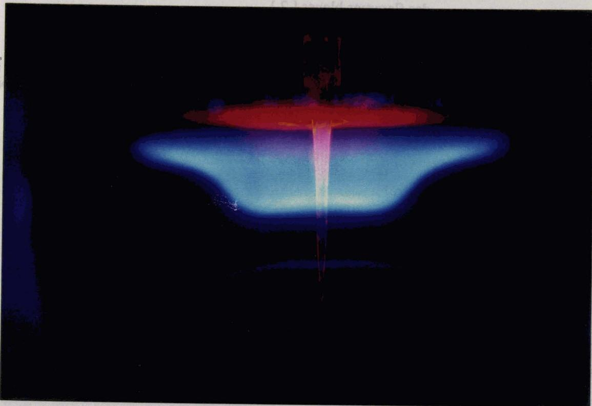
Figure II.29 : Flamme en deux stades avec la sonde de prélèvement : P = 1.8 bar.
