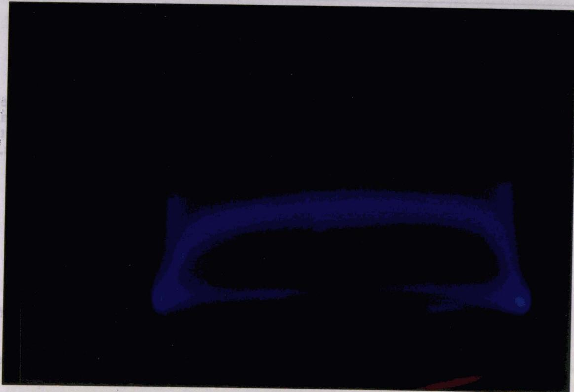
Figure II.28 : Flamme froide seule : P = 1.4 bar.
