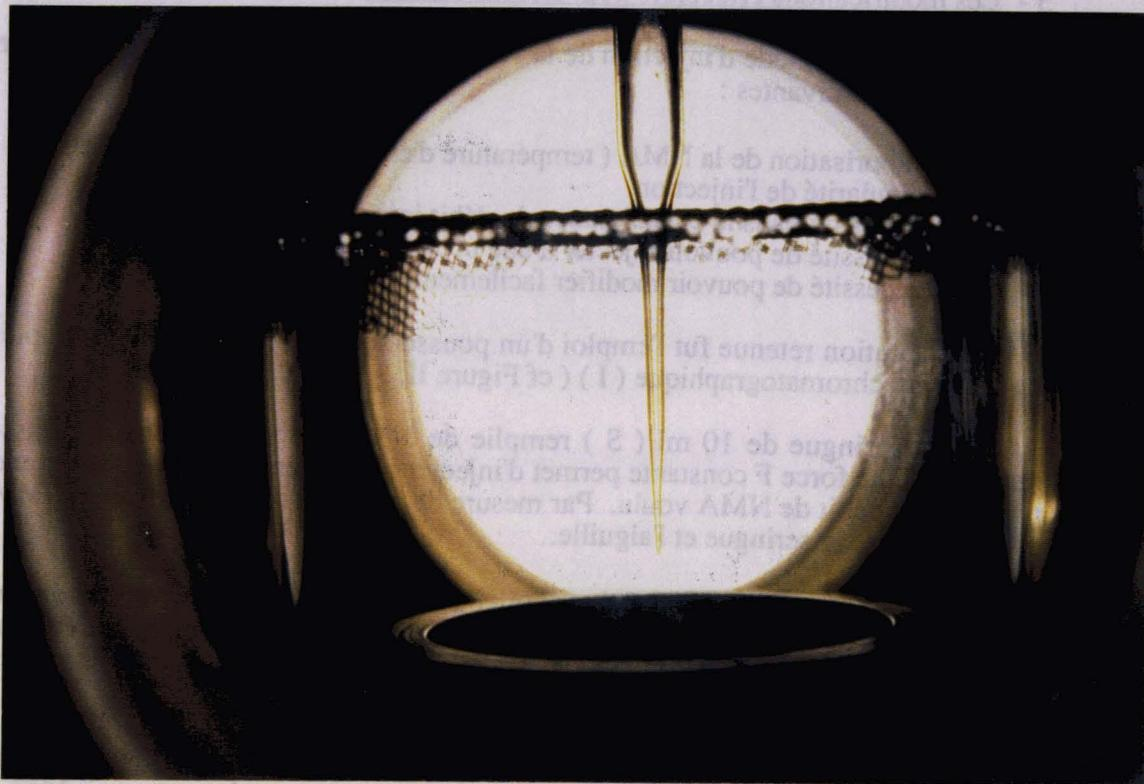
**Figure II.8 :** Sonde de prélèvement dans l'enceinte pressurisable.
