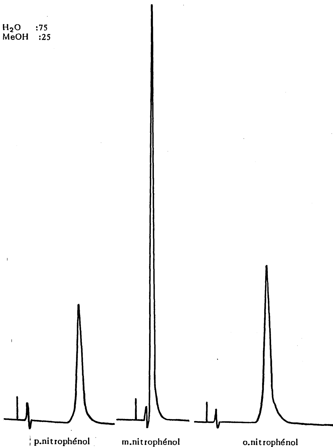
Fig IV.11 : chromatogrammes HPLC des isomères ortho, méta et para du nitrophénol
