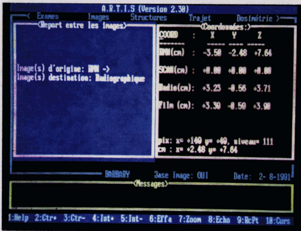
Fig IV.19 b- L'utilisateur obtient les coordonnées dans les différents systèmes d'imagerie en écho sur le moniteur.
