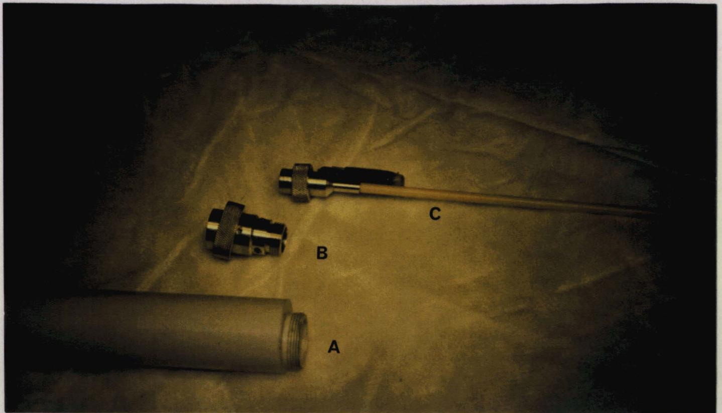
Figure II-2 : Première maquette d'étude comportant trois parties : A (enveloppe en ertalite), B (support de lentille), C (guide d'onde).
