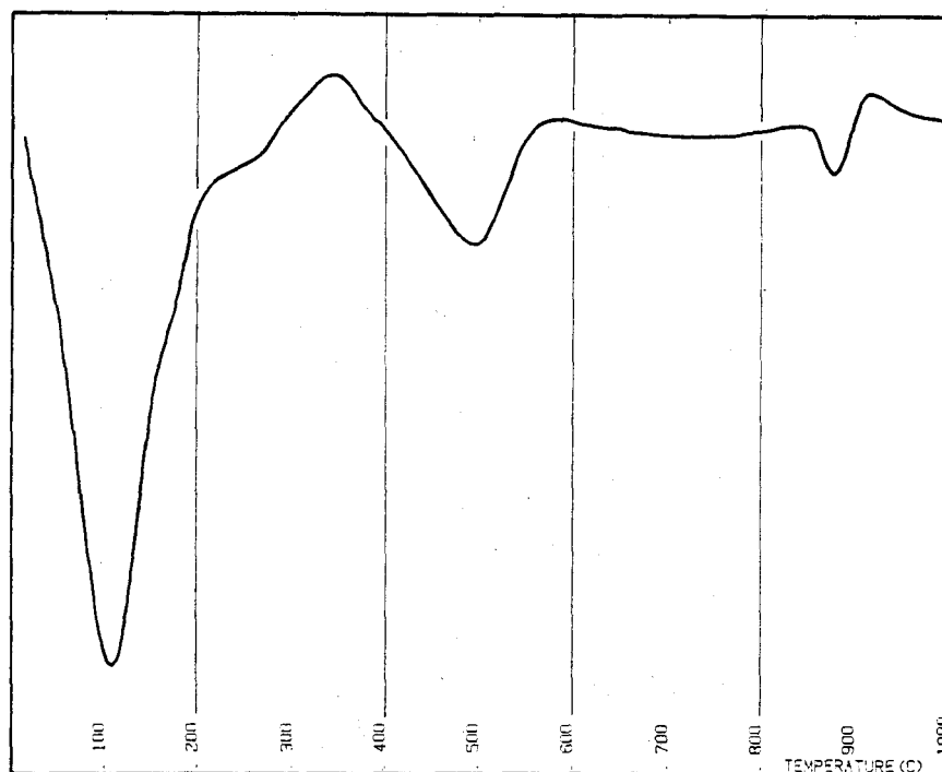
Fig. 40: Courbe d'analyse thermique différentielle de smectite santonienne d'Agadir (échantillon Asr 13).
