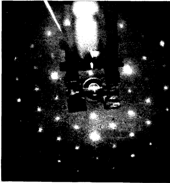
Fig.IV.40: Diagramme de diffraction d'électrons lents à E_p = 100 eV obtenu sur un film de 7\text{\AA} de fer déposé après recuits progressifs ( 250\text{--}450^\circ\text{C} ).
